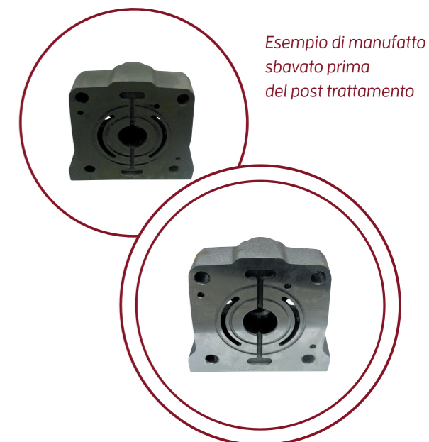
Esempio di manufatto sbavato dopo la disossidazione
